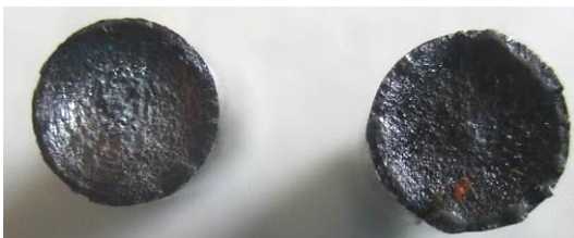
Рис. 5. Поверхность излома осевых сердечников диаметром 5, и 6 мм
